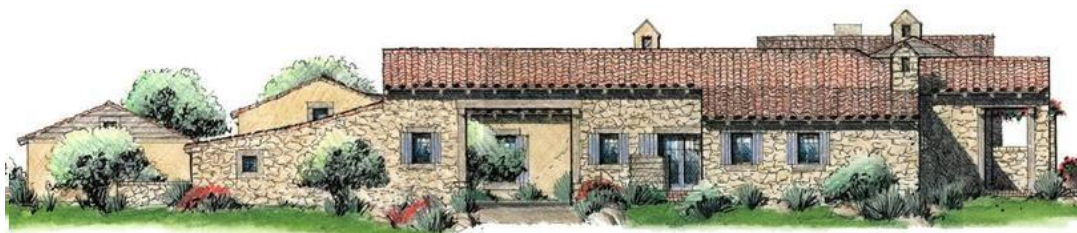
Paredes de piedra y revoque
